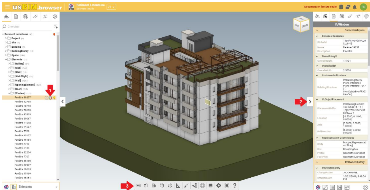
Figure 4. Affichage de l'arborescence IFC et des propriétés des objets
