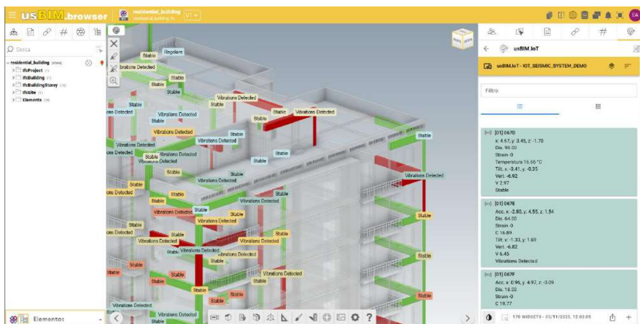
Ilustración 1-usBIM.IoT, adquirir datos desde sensores físicos directamente en el modelo IFC
